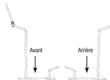
3. Installez la base sur les attaches, voir l'illustration.
